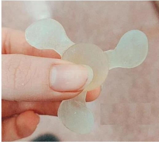
Figura 7-Hélice impresa por SLA | Foto propia
