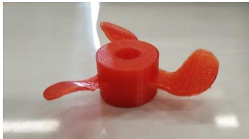
Figura 6 - Hélice impresa por FDM. Laboratorio LMFA | Foto propia
