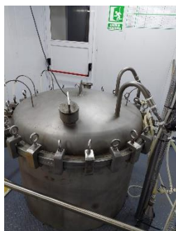
Figura 3, Equipo de esterilización del tipo autoclave con regulación de presión, temperatura y tiempo de esterilización. Fuente: Empresa Biagro
