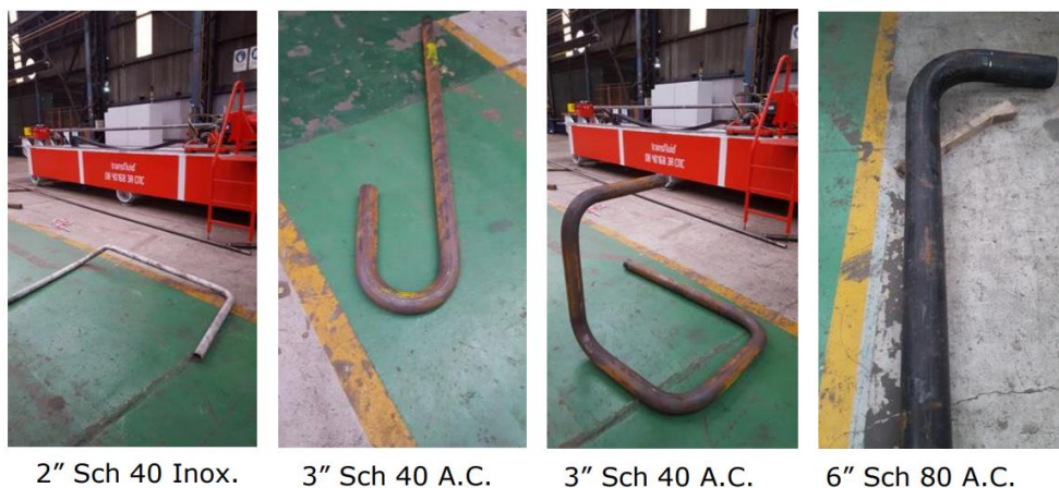
Figura 4 – Imágenes de ejemplares curvados en distintas combinaciones de materiales, diámetros, schedule y radios de curvatura (Fuente: AESA).
